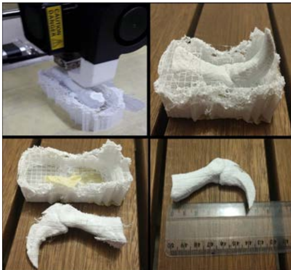
Figura 2. Processo de impressão da garra. A) Impressão 3D; B) Impressão finalizada no suporte; C) Objeto retirado do suporte, com rebarbas de filamento PLA; D) Garra finalizada, após desgaste por lixamento.
